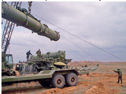
Заряжание пусковой установки
